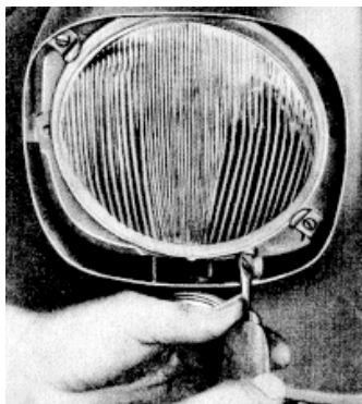
Bild 25. Einstellen des Scheinwerfers
