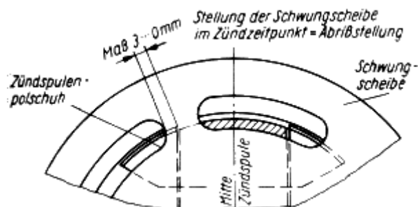
Bild 16. Kontrolle des Abrisses
